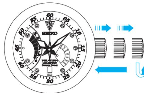
1. Ziehen Sie die Krone zur zweiten Einrastposition heraus, wenn der Sekundenzeiger sich auf der 12-Uhr-Position befindet.
