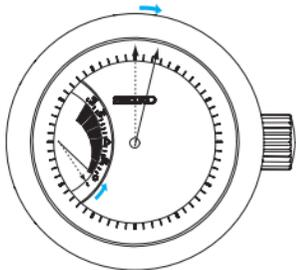
2. Nach der Energieerzeugung durch Drehen der Krone für eine bestimmte Zeitdauer zeigt der Direktantriebszeiger auf die Skalenmarkierung 0 und der Sekundenzeiger fängt an zu laufen. Hören Sie auf, die Krone zu drehen, und überprüfen Sie diesen Zustand.
