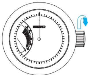
1. Drehen Sie die Krone wiederholt im Uhrzeigersinn, um die Uhr aufzuladen.
