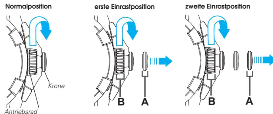
Ziehen Sie zum Herausziehen der Krone den **Abschnitt A** (Krone) heraus. Zum Drehen der Krone drehen Sie den **Abschnitt B** (Antriebsrad).
